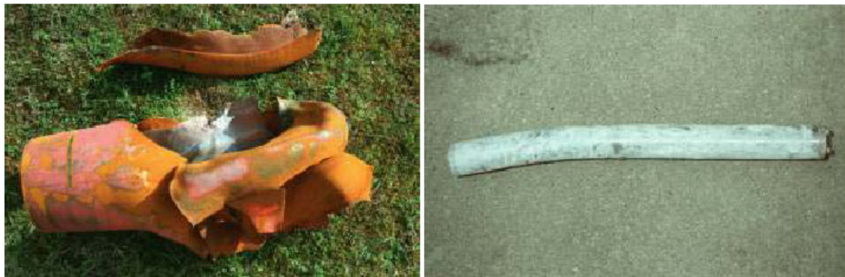
Figure 4 : Exemple de l'impact d'un engin explosif sur l'enveloppe intermédiaire en cuivre (à gauche) et le cylindre interne (à droite) d'un FS47
